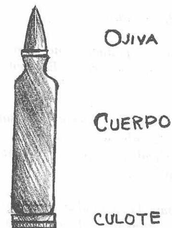
Ojiva: Primera parte del proyectil, tiene forma cónica y termina en punta. Está compuesto de núcleo de plomo y envoltura de latón. (3).
