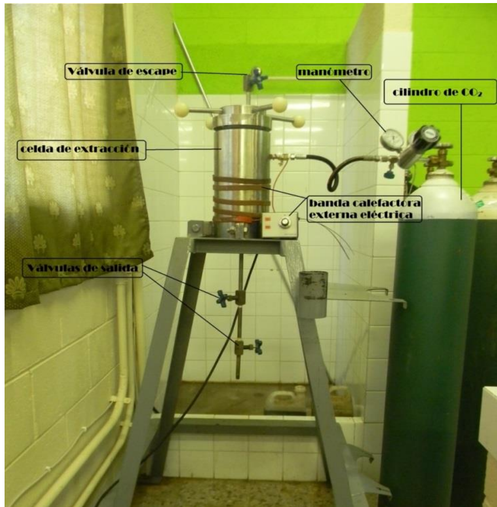
Figura 10.5. Foto esquema del extractor supercrítico utilizado, ubicado en el Laboratorio Ambiental del CUNORI-USAC.
